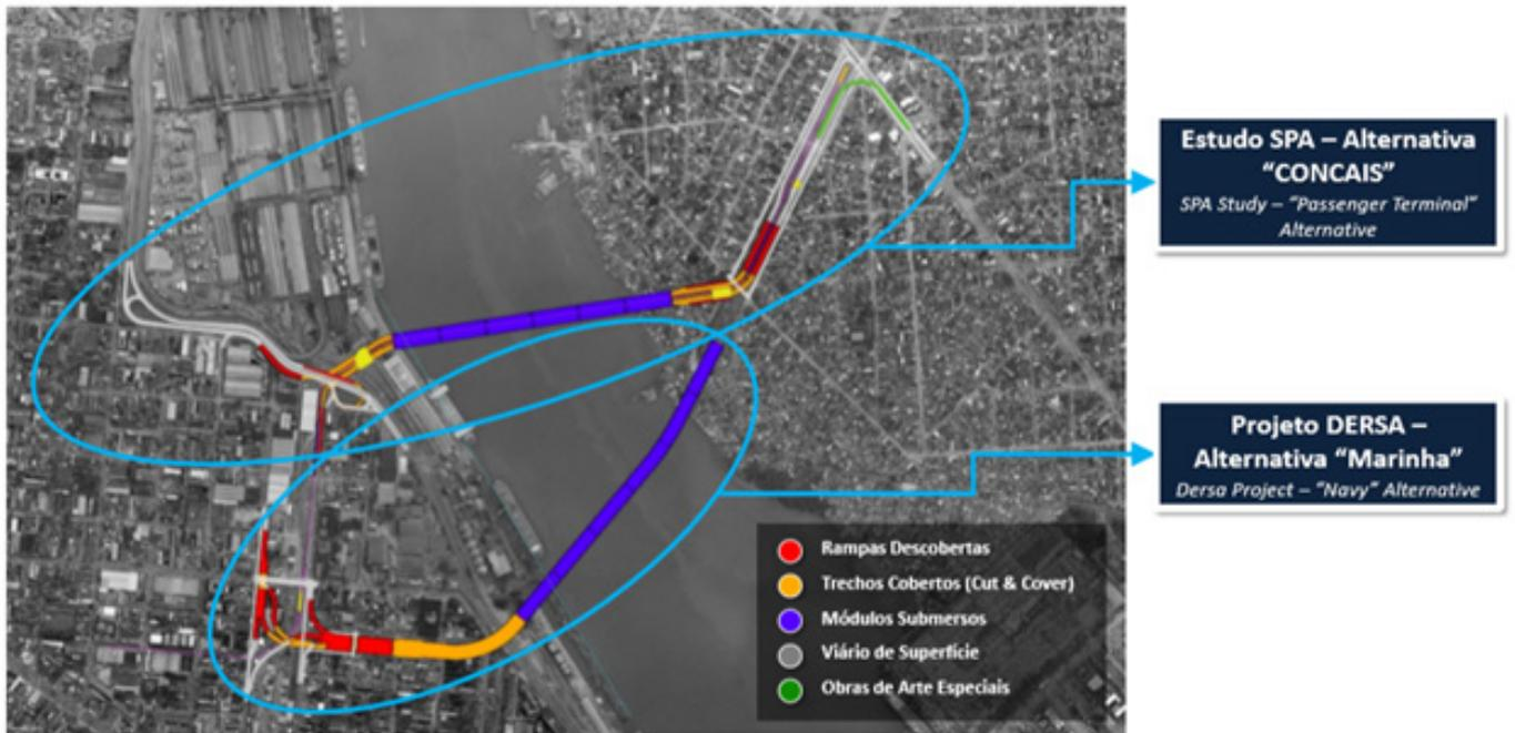
Figura 1 – alteração do traçado do túnel projetado, mantendo o local de chegada no Guarujá
